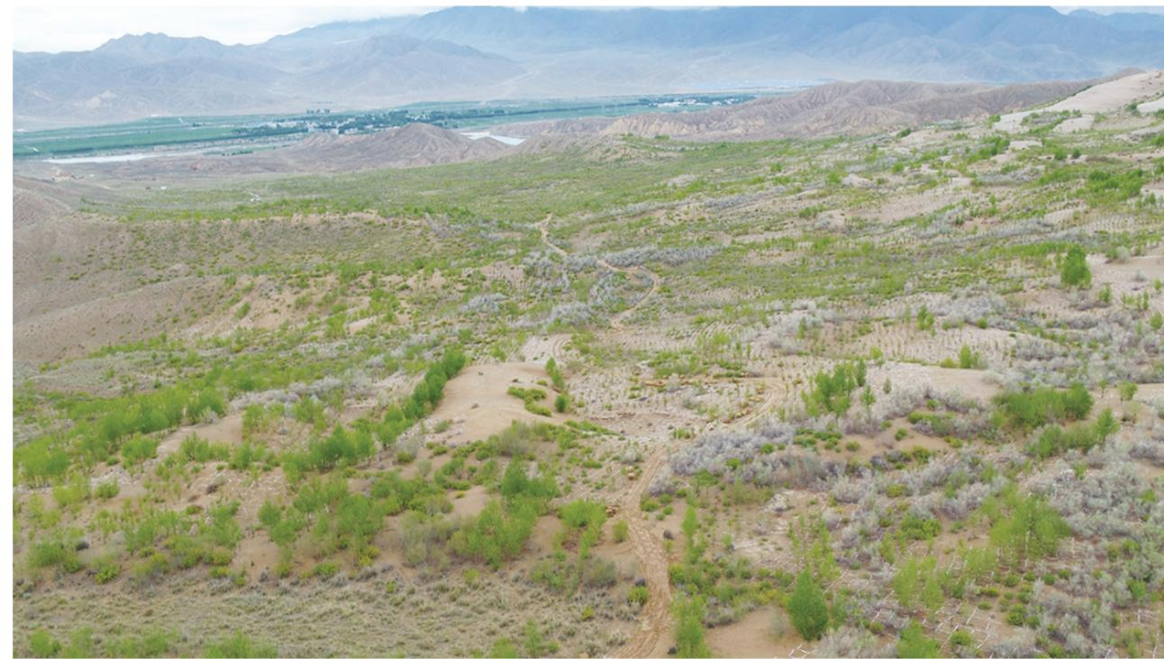
中断,踩下至沙层10—20厘米,地上露出10—20厘米,沙障厚度为4—6厘米,
