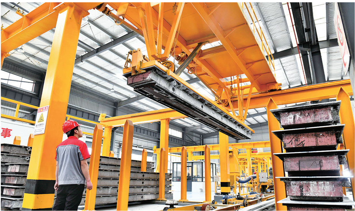
5月28日,在嘉祥县国家级装配式建筑产业园,工人在生产线上操作机械,加工装配式建材混凝土砌块。 山东省济宁市嘉祥县依托建筑和建材产业优势,通过政策引导、产业扶持等措施,培育壮大装配式建筑产业,推进建筑业绿色低碳发展。据悉,2022年嘉祥县装配式建筑产业产值31.75亿元,装配式建筑产业已成为当地促进经济高质量发展的特色主导产业。 新华社记者 郭绪雷 摄
