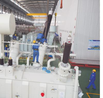
4月1日,在浙江白云渐变电气设备有限公司,工作人员在厂房装配22万伏特高压油浸式变压器。该公司输变电设备出口全球,一季度产值达2.2亿元。
