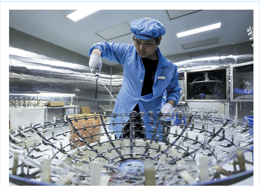
7月10日，在江西科强光学有限公司镀膜车间，工人给完成镀膜的镜片除尘。
